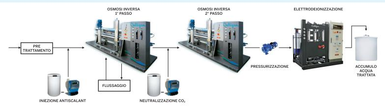
DOPPIO PASSO OSMOSI INVERSA + NEUTRALIZZAZIONE CO<sub>2</sub> + ELETTRODEIONIZZAZIONE Qualità finale 10-18 MOhm·cm
