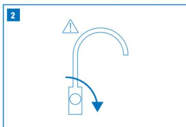
2 Chiudere l'alimentazione idraulica in ingresso.
