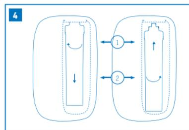
4 Per rimuovere: girare in senso orario e tirare per inserire spingere girare in senso antiorario
